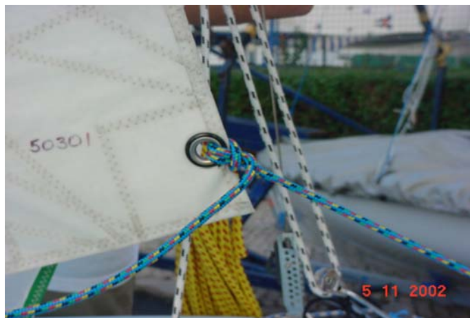
Figura 23 – modo de fixar a escota do estai
