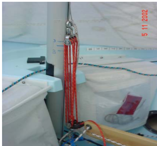
Figura 14 – sistema de tensão
