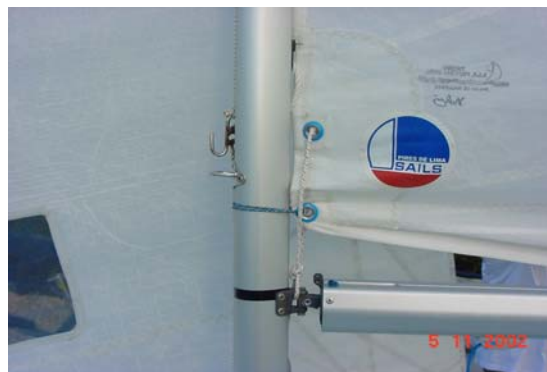
Figura 24 – punho da amura: exemplo com o cabo caçado
